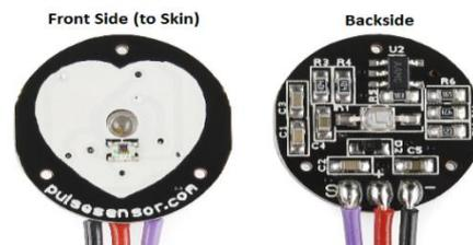
Gambar 3. Sensor *Pulse* Tampak Depan dan Belakang
