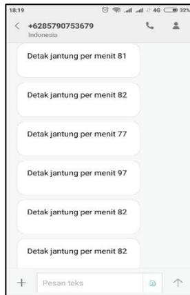
Gambar 9. Hasil Pengujian sistem SMS gateway sim800L
