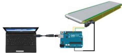
Gambar 6. Skema Rangkaian *Hardware* Desain Sistem Pengaturan PID Motor DC sebagai Penggerak Mini Conveyor Berbasis Matlab. (Sumber: Data Primer, 2017)
