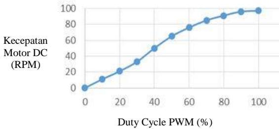
Gambar 9. Grafik Pengujian Driver Motor DC (Sumber: Data Primer, 2018)
