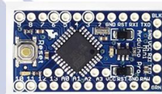
Gambar 1. Arduino Pro Mini (Sumber: https://www.arduino.cc/usa/arduino-pro-mini , 2017)
