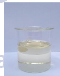
Gambar 9. Minyak Transformator Baru (Sumber : Data primer, 2019)
