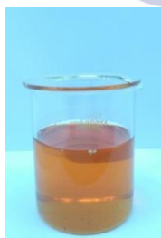
Gambar 12. Minyak Transformator yang Sudah Digunakan (Sumber : Data primer, 2019)
