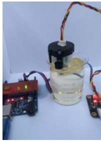
Gambar 10 Pengujian pada Sampel Minyak Transformator Baru (Sumber : Data primer, 2019)
