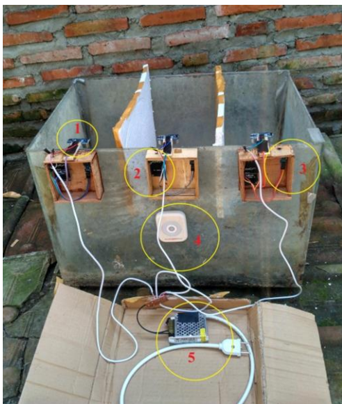
Gambar 6. Prototype Monitoring Ketinggian Air Pada Bendungan
