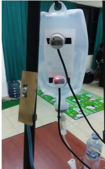
Gambar 9. Pembacaan data Sensor XKC-Y25-V
