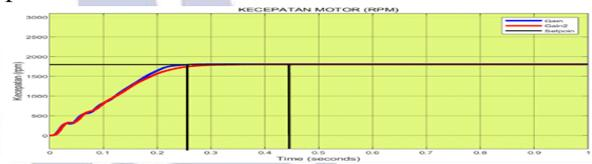
Gambar 15. Grafik putaran motor dengan kontrol PID fuzzy logic dan tanpa kontrol serta tanpa beban
