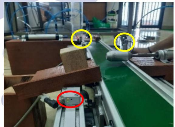
Gambar 10. Kondisi Sensor *Photoelectric* 3 Ketika Mendeteksi Barang
