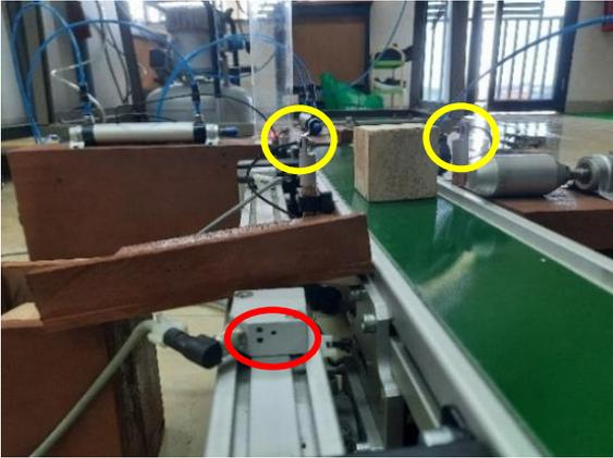
Gambar 11. Kondisi Sensor Photoelectric 3 Ketika Tidak Mendeteksi Barang
