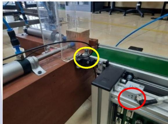
Gambar 9. Kondisi Sensor *Photoelectric* 2 Ketika Tidak Mendeteksi Barang
