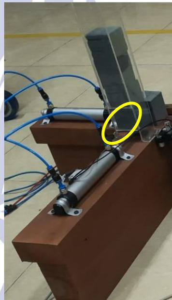
Gambar 13. Kondisi Silinder Pneumatik 1 Mendorong Barang
