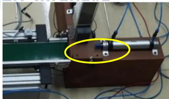
Gambar 14. Kondisi Silinder Pneumatik 2 Kondisi Normal
