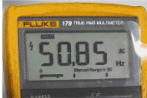
Gambar 8. Pengujian Frekuensi Maksimal Motor 3 Fasa
