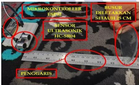
Gambar 8. Pengujian Parsial Sensor Ultrasonik
