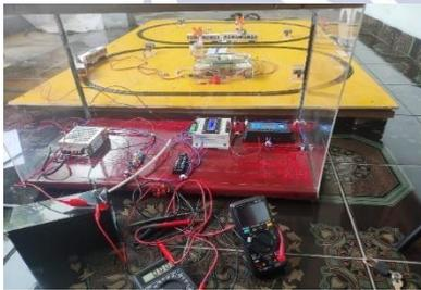
Gambar 11. Pengujian Switch ATS Hybrid
