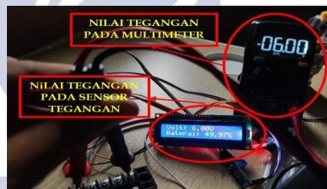
Gambar 7. Pengujian Parsial Sensor Tegangan
