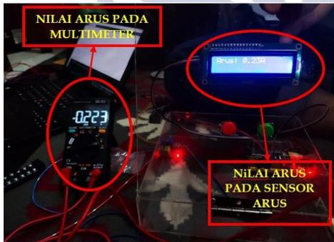
Gambar 6. Kalibrasi Sensor Arus
