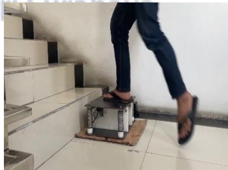
Gambar 4. Cara Kinerja Alat Prototipe Pembangkit Listrik Tenaga Pijakan Kaki
