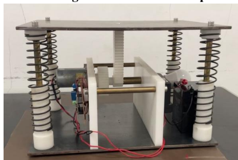
Gambar 3. Hardware Prototipe Pembangkit Listrik Tenaga Pijakan Kaki
