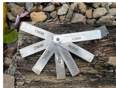
Gambar 8 alat ukur khusus yang ditempatkan pada celah antara lidah wesel dan rel lantak saat posisi dirapatkan
