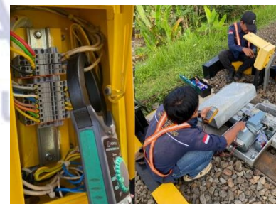
Gambar 6 Pengujian tegangan dan arus wesel Siemens BSG-9
