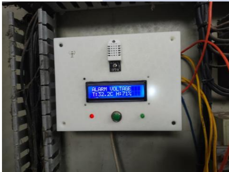
Gambar 11. Kondisi hardware saat pengujian respons alarm dan proteksi
