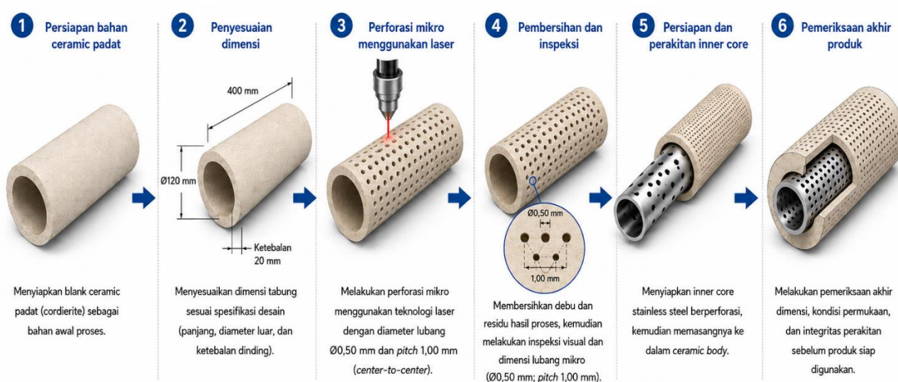
Gambar 2. Alur proses pembuatan DPF ceramic
