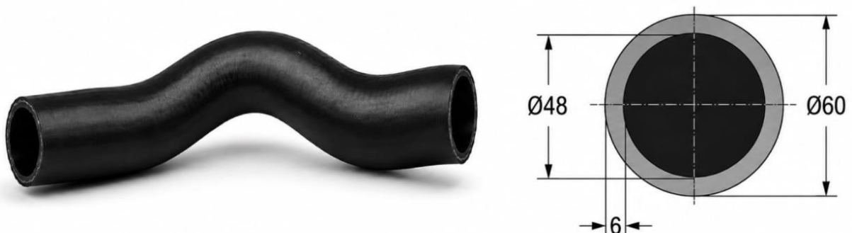
Gambar 5. Produk Selang Radiator Diameter 60 mm, Panjang 500 mm, Tebal 6 mm
