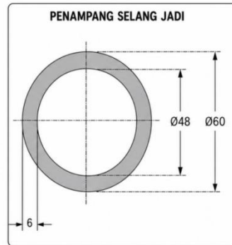
Gambar 3. Cetakan Atas dan Cetakan Bawah Selang Radiator dan Penampangnya
