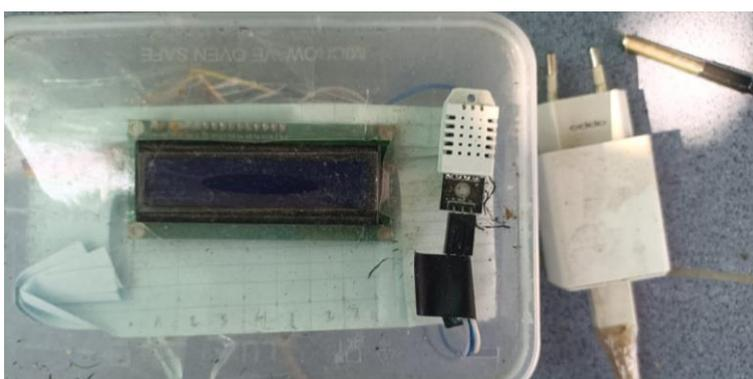
**Gambar 3.** Tampak Luar Alat Monitoring Suhu dan Kelembapan di Sekitar Kolam
