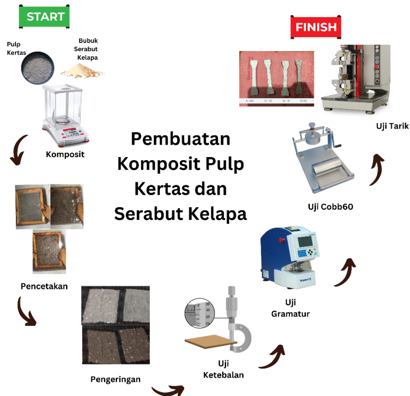
Gambar 3 Fabrikasi Komposit Kertas Ramah Lingkungan (Pulp Kertas dan Cocopeat )
