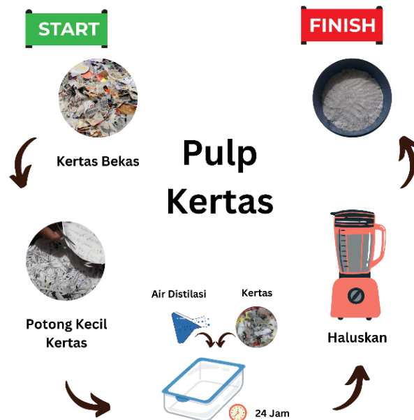
Gambar 1 Ilustrasi Pembuatan Pulp Kertas
