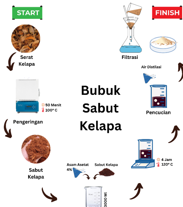
Gambar 2 Ilustrasi Pembuatan Cocopeat
