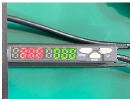
Gambar 4. Kalibrasi Set Value pada Sensor BF5R
