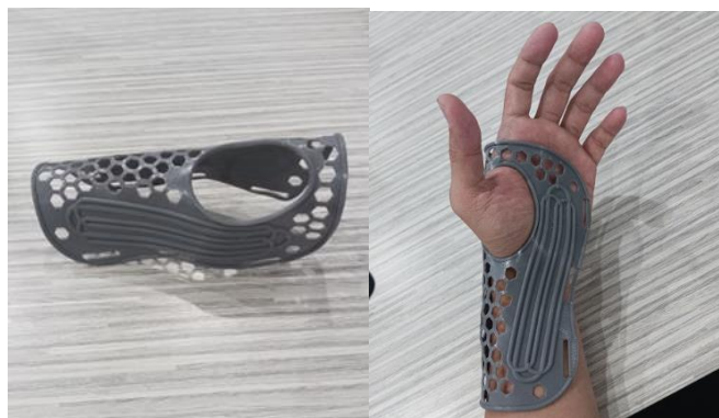
Gambar 2. Bentuk Bidai 3D Print (kiri) dan Kondisi Bidai Terpasang pada Tangan (kanan)
