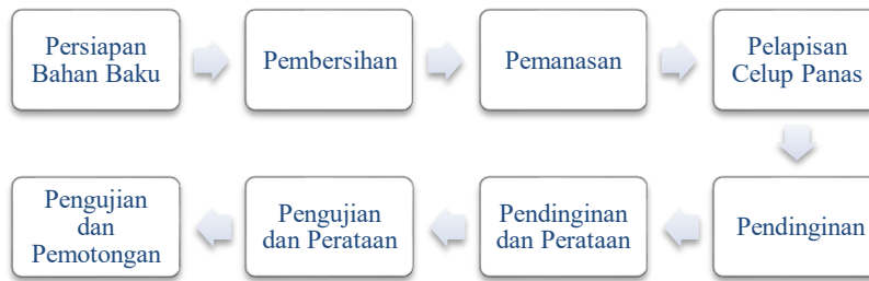
Gambar 1. Skema Proses Produksi BjLAS (Hasan, 2022)
