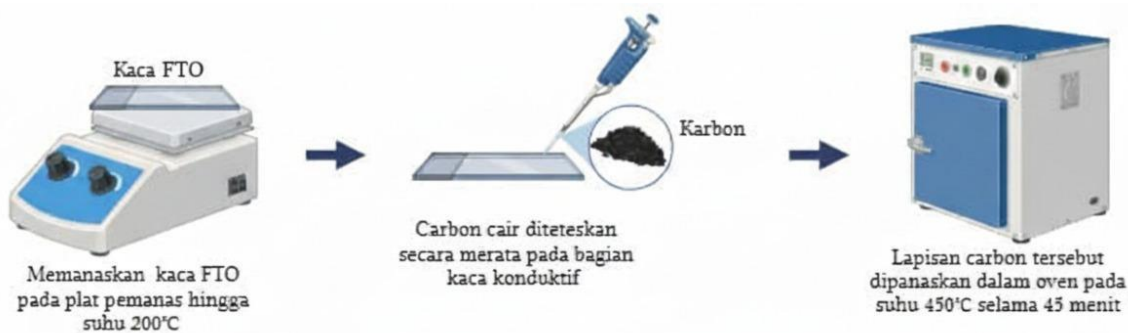
Gambar 3. Skema proses counter elektroda pada kaca FTO
