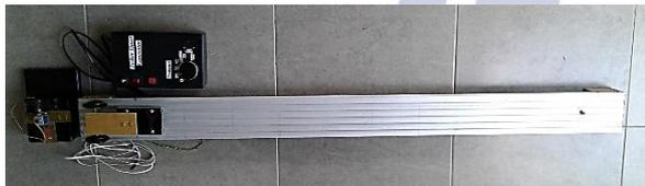
Gambar 7. Alat Peraga *Ticker Timer* yang dikembangkan
