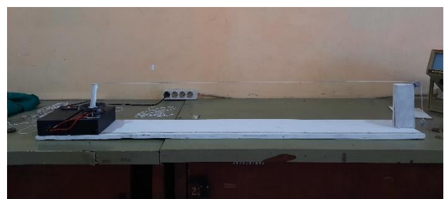
Gambar 5. Alat peraga Hukum Melde (Sumber: Dokumentasi penulis)
