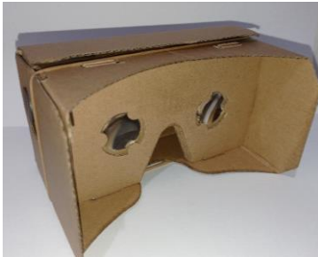
Gambar 4. VR Cardboard yang telah di rakit
