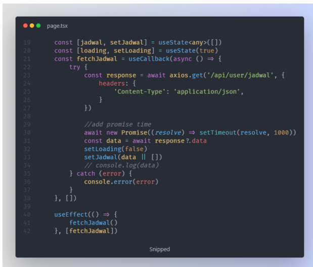
Gbr. 15 Fetching data pada React Hooks di sisi klien
