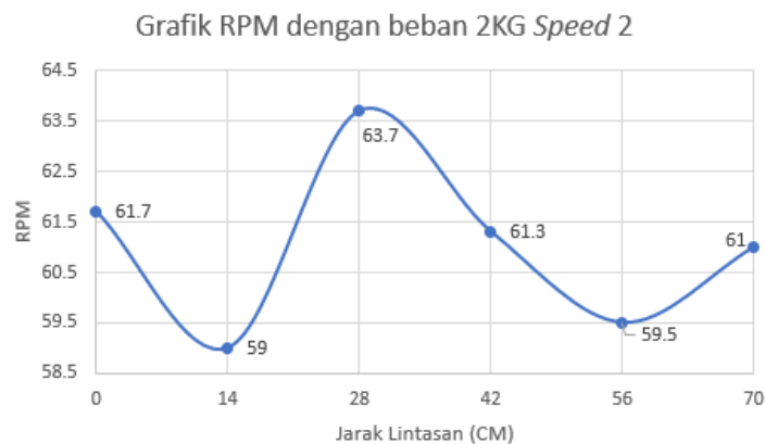
Gambar 11. Grafik Pengujian RPM speed 2 dengan beban 2 KG menggunakan Tacho Meter
