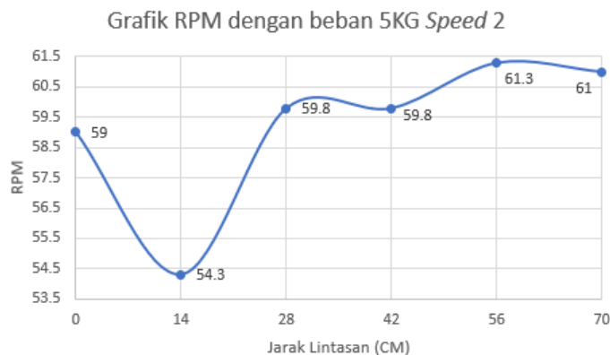
Gambar 12. Grafik Pengujian RPM Speed 2 dengan beban 5 KG menggunakan Tacho Meter
