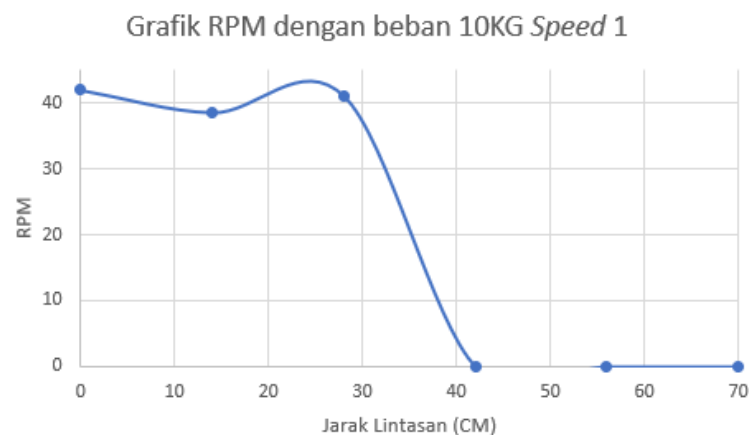
Gambar 9. Grafik Pengujian RPM Speed 1 dengan beban 10 KG menggunakan Tacho Meter
