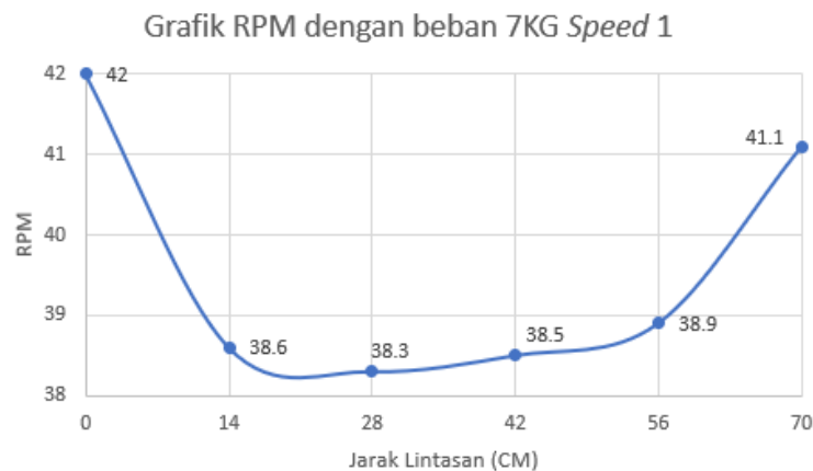
Gambar 8. Grafik Pengujian RPM Speed 1 dengan beban 7 KG menggunakan Tacho Meter
