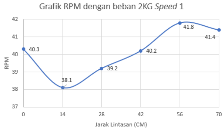
Gambar 6. Grafik Pengujian RPM Speed 1 dengan beban 2 KG menggunakan Tacho Meter
