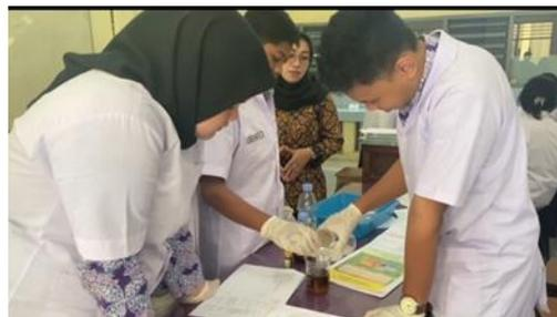
Gambar 4. Mencampurkan minyak jelantah dengan soda api (NaOH)
