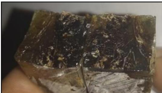
Gambar 6. Permukaan patahan *bending* spesimen 25%
