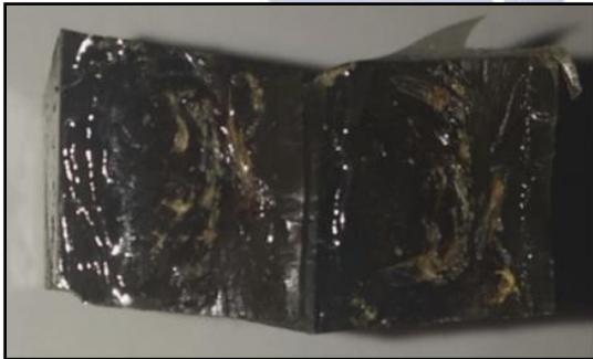
Gambar 5. Permukaan patahan *bending* spesimen 15%
