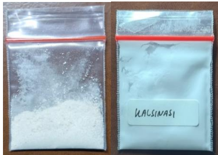
Gambar 2. Hasil Sebelum dan Sesudah kalsiniasi serbuk cangkang telur.
