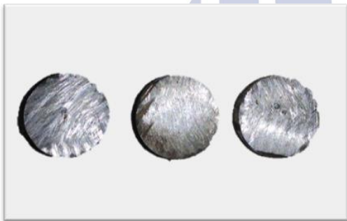
Gambar 3. Spesimen Baja SS400 yang akan diberi perlakuan
