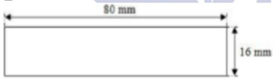
Gambar 6. Spesimen Uji Bending
