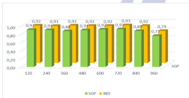
Gambar 31. Grafik Rata-Rata Percepatan Getaran Variasi Fork Spring SGP dan IND dengan Variasi RPM
