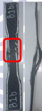
**Gambar 12.** Patahan Spesimen Pada Fraksi Berat Serat 20 wt%
