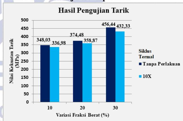
**Gambar 8.** Nilai Uji Tarik Spesimen
