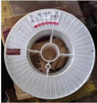
Gambar 2. Elektroda hyundai dcep E71T-1
