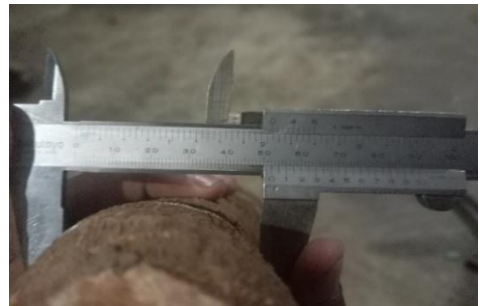
Gambar 5 Pengukuran Diameter Terbesar
