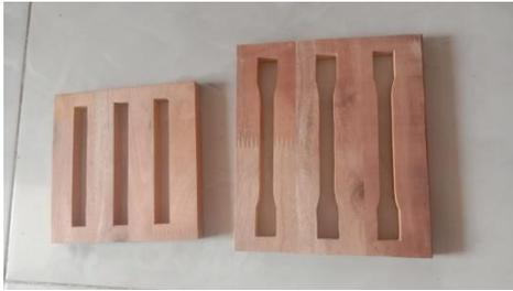
Gambar 3. Cetakan Spesimen
