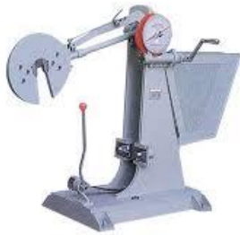
Gambar 3. Alat Uji Impak
