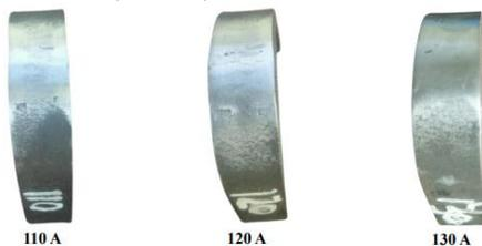
**Gambar 9.** Hasil Pengujian Bending Variasi Arus 110 A, 120 A, 130 A
