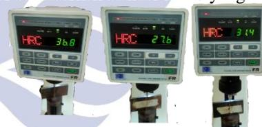
Gambar 9 Pengujian kekerasan *rockwell C*
