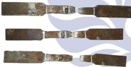
**Gambar 6** hasil dari spesimen setelah dilakukan pengujian tarik
