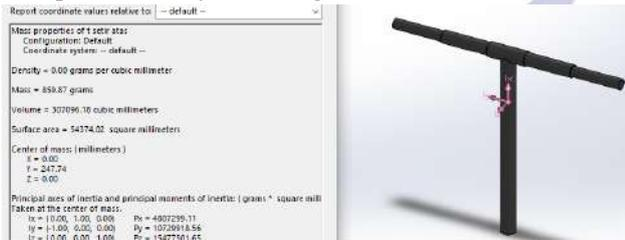
**Gambar 9** Berat Rangka Setir *E-Folding Scooter*
