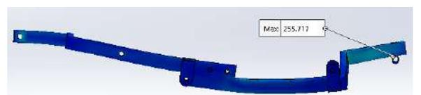
**Gambar 27** Ilustrasi Rangka Saat Uji *Stress*
