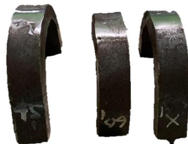
Gambar 10. Bengkokan Spesimen Uji Bending
