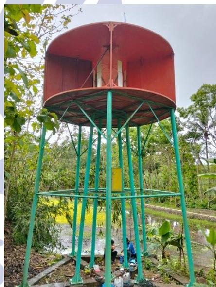
Gambar 1 Turbin angin sumbu vertikal 5kW menggunakan *nozzel* konvergen
