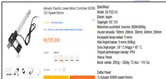
Gambar 12. Motor linear JS-TGZ-U3
