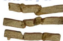
Gambar 4.5 Spesimen uji impak fraksi volume 10%SK:30%SJ, 2jam
