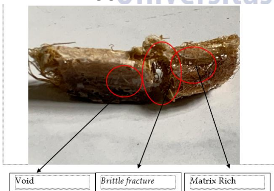
Gambar 4. 8 Bentuk patahan uji impact
