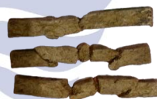
Gambar 4.4 Spesimen uji impak fraksi volume 20%SK:20%SJ, 4jam
