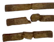
Gambar 4.2 Spesimen uji impak fraksi volume 30%SK:10SJ, 4jam
