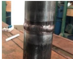
Gambar 2. Hasil Pipa yang Telah Dilas
