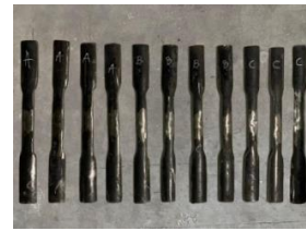
Gambar 4. Hasil Pembuatan Spesimen
