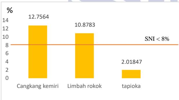
Gambar 2. Diagram batang kadar abu bahan baku briket
