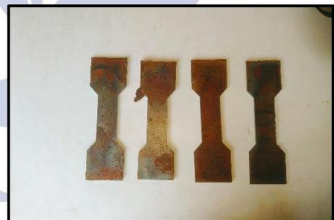
Gambar 3. Spesimen Uji Tarik
