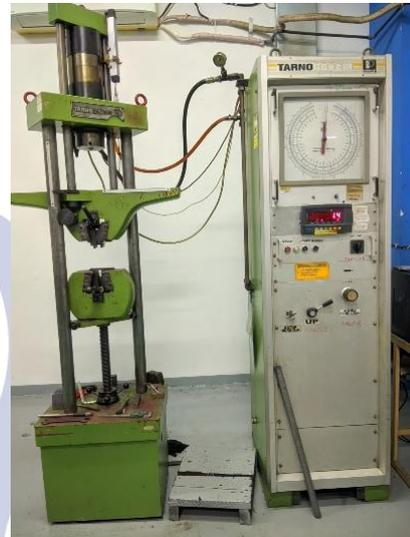
Gambar 3 Mesin Uji Bending
