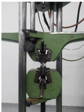
Gambar 2. Mesin Uji Tarik
