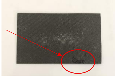
Gambar 11. Void Pada Composite
